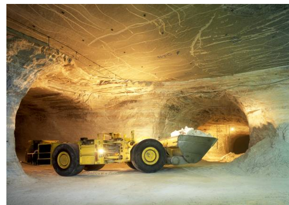
Abb. 72: 17-Tonnen-Diesellader in einem Grubenbetrieb der K+S KALI GmbH (Foto: K+S Aktiengesellschaft, Kassel)
