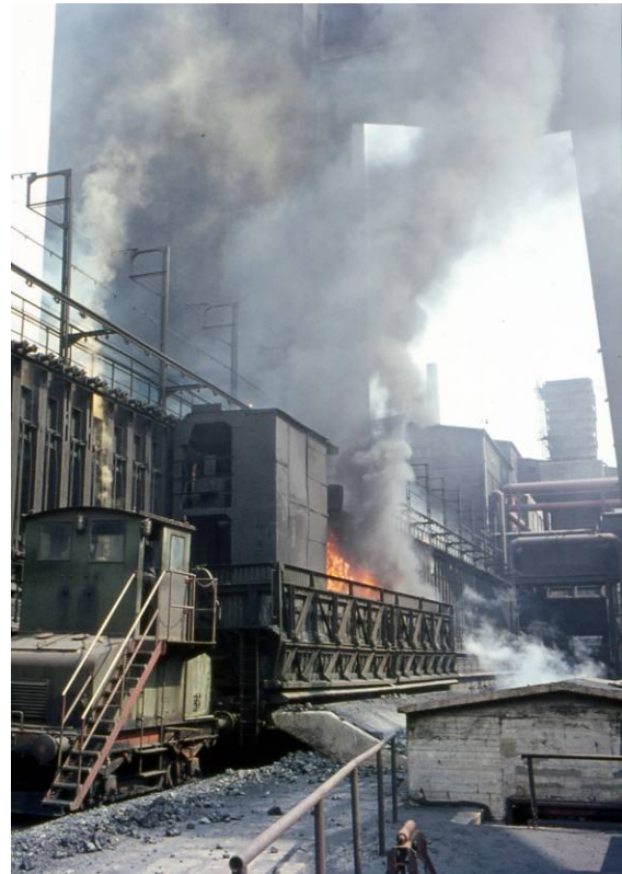
Abb. 83: Koksdrücken an der Batterie A/B der Kokerei Kaiserstuhl II, Dortmund, undatiert (Archiv Koßke)
