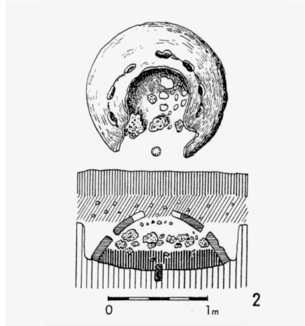
Abb. 67: Kuppelförmiger Rennofen. Mechlin, Polen, frühe römische Kaiserzeit (Pleiner 1965, Abb. 7).
