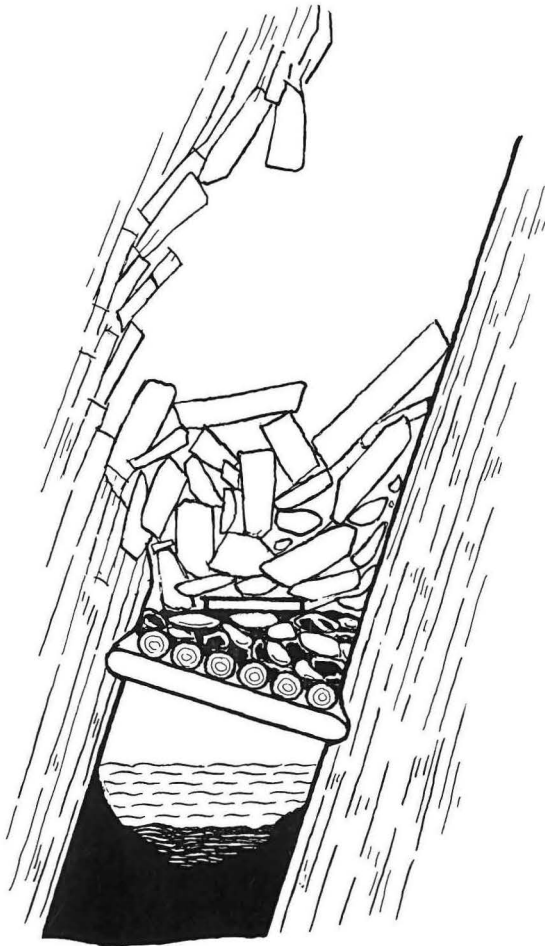
Erbstollen mit geschlossener Wasserseige, dessen Fördertrum durch zu tief geführten Abbau verbrochen ist. Alle Zeichnungen Erich Schürbusch, Wattenscheid.
