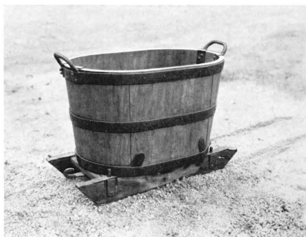
Schlitten mit Förderkübel. Die Schlitten dienten vornehmlich der Streckenförderung. Sie wurden an Sielen entweder auf glatter Sohle oder auf Holzbohlen gezogen.
