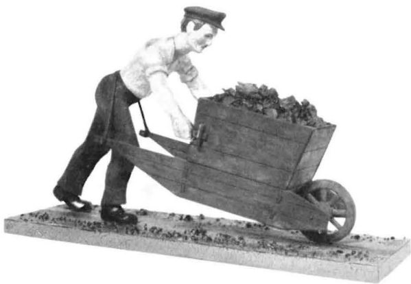
Karrenläufer mit Hohlkarre, die der Karrenläufer an einer über das Kreuz gelegten Stiele trug, wobei er sich mit den Händen auf die am Karrenkasten angebrachten Handgriffe stützte. Diese Art der Förderung war besonders in niedrigen Stollen üblich.
