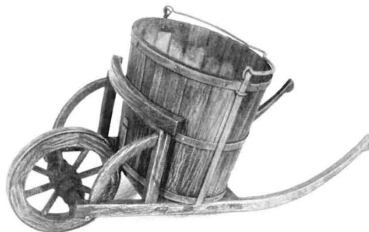
Bockkarre für die Streckenförderung beim Tiefbau. Der Schachtförderkübel wurde dabei vom Seil abgehängt, auf die Karre gesetzt, zum Abbau gefahren und dort gefüllt, wodurch auf der ganzen Strecke kein Umladen erforderlich war.
