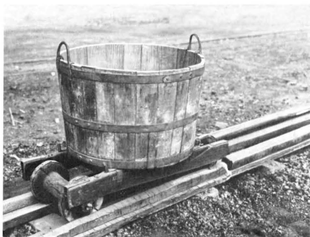
Rollwagen mit Förderkübel auf Holzschienen. Diese Wagen dienten vornehmlich der Streckenförderung. Statt der Räder benutzte man bei ihnen vielfach noch Holzwalzen. Mit den Ösen wurde der Kübel bei der Schachtförderung an das Seil gehängt.
