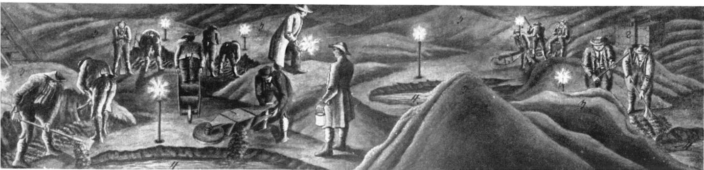
Abb. 19: Die an den Wänden der Laugkammer abgelagerten Tonrückstände werden abgetragen und in Vertiefungen der Werkssohle verstürzt. Ein Grubensteiger mit Öllampe und ein höherer Bergbeamter (Bergschaffer) mit Kerzenlaterne kontrollieren die Arbeit. (Tabelle LIII der Manipulationsbeschreibung von 1837.)
