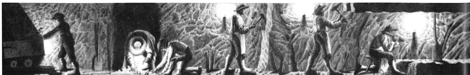
Abb. 6: „Stellt die Nachschlagung einer Kehr, die praktische Angabe zu einer Sohlen- oder Firstenwag und die Wegförderung des Hauer Gebirgs auf der Gestengfahrt vor.“ (Tabelle LXVIII/A der Manipulationsbeschreibung von 1836.)
