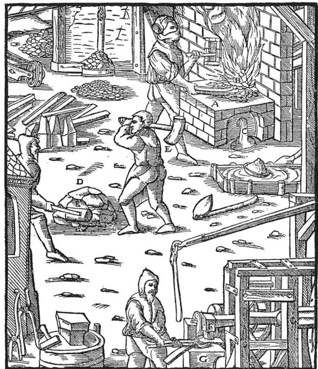
▲ G. Agricola, 1556: Rennfeuer und Schwanzhammer, A Herd, B Beschickungshaufen, C Schlackenabfluß, D Eisenklumpen (Massel), E Holzhämmer, F großer, eiserner Hammer, G Amboß. Seite 7: Frischfeuer zur Stahlbereitung: A Frischfeuer, B Blasebälge
