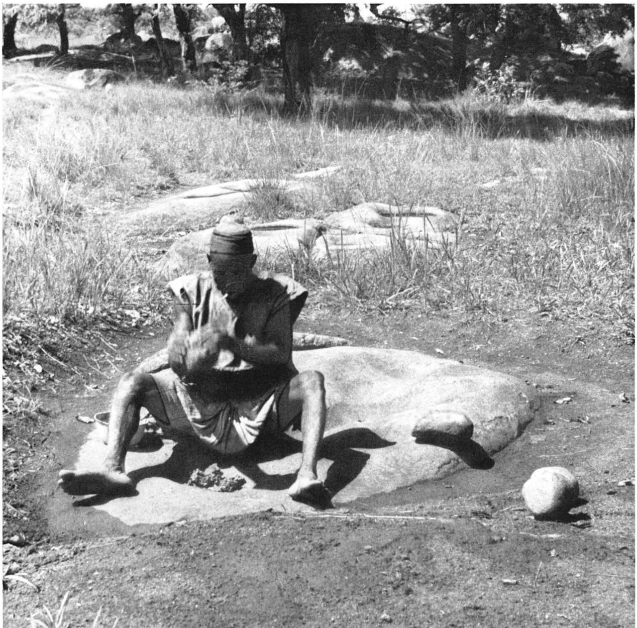
Viele Schmiede gehen – selbst aus einer Entfernung von 12 km – nach Koko, einem abgelegenen Teil von Koni, wo sich eine von Granitblöcken und -platten übersäte Stelle befindet, um dort das Roheisen zu Eisenpulver zu zerstampfen. Die dortigen Felsplatten besitzen bis zu 25 cm tiefe Mulden mit einem Durchmesser bis zu 65 cm. Daneben oder darin liegen handlich geformte, rundliche, fast kopfgroße graue Granitsteine (Abb. 15).
