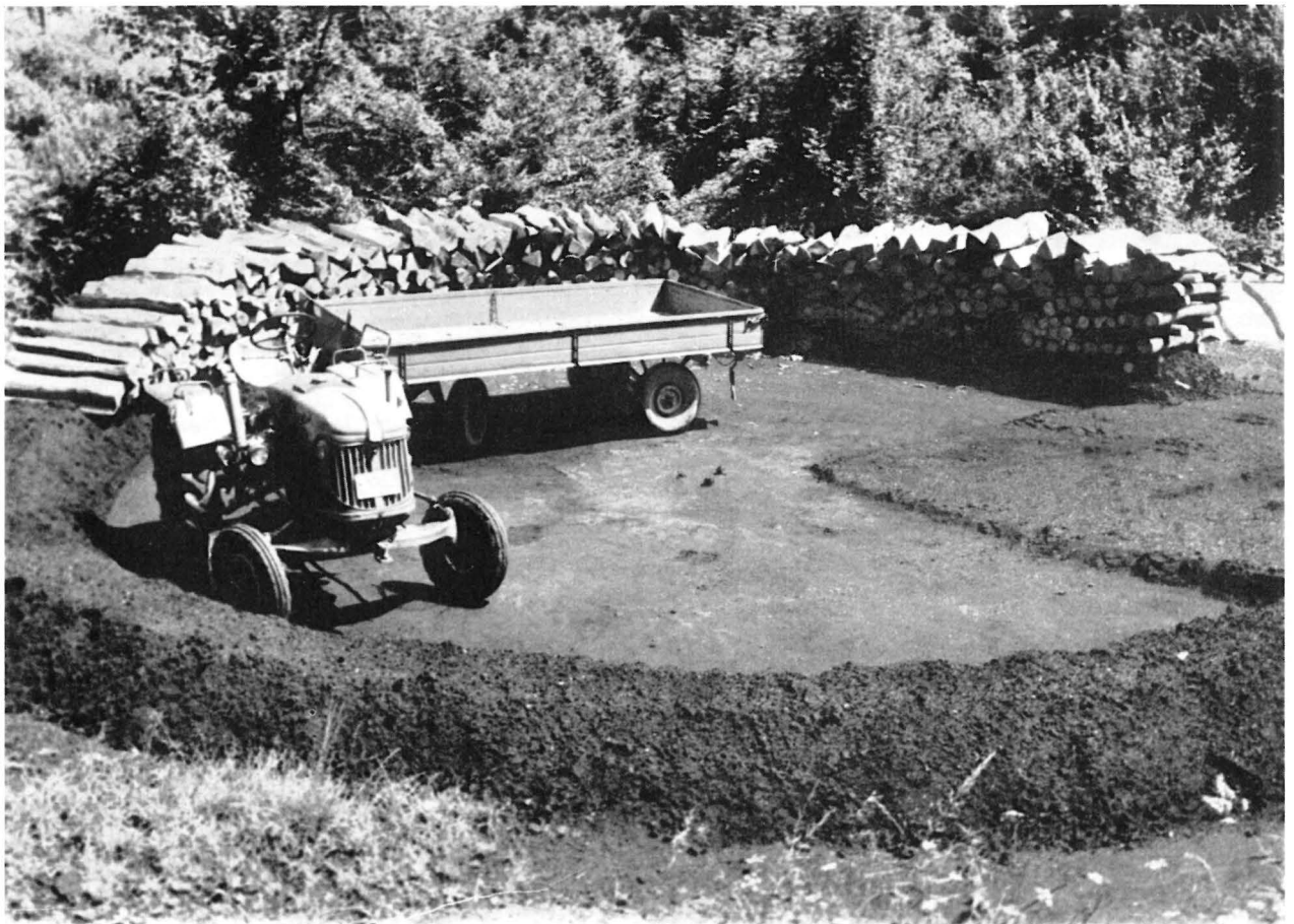
Abb. 1: Das Buchenholz wird angefahren und rund um die Kohlplatte auf der wallartig aufgeschichteten Erde abgelegt
