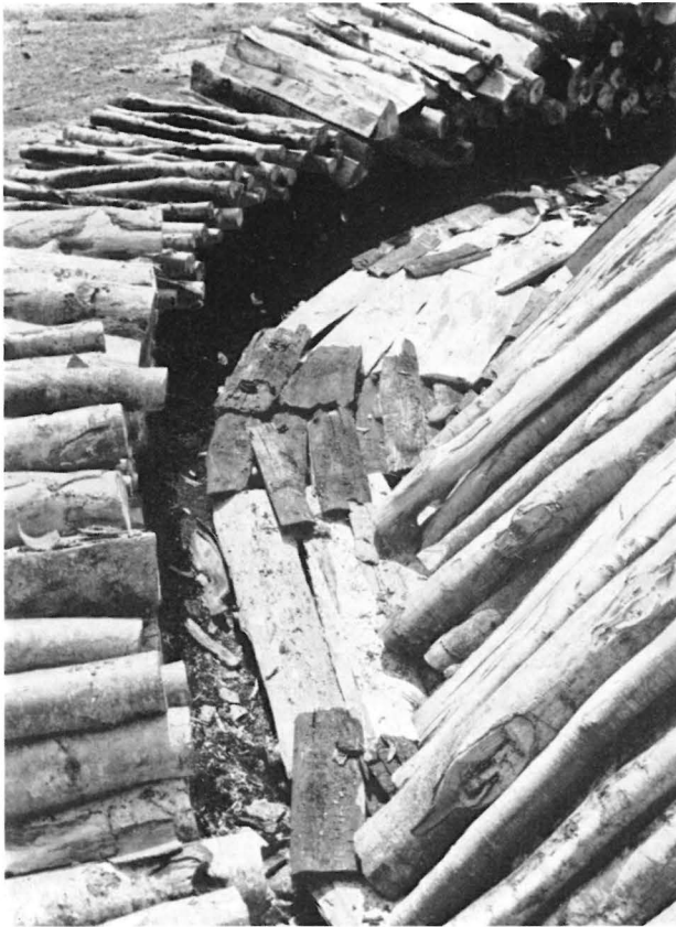
Abb. 3: Die aus Schwartlingen bestehende Meilerbrücke ermöglicht beim Brennen den Luftzutritt von unten
