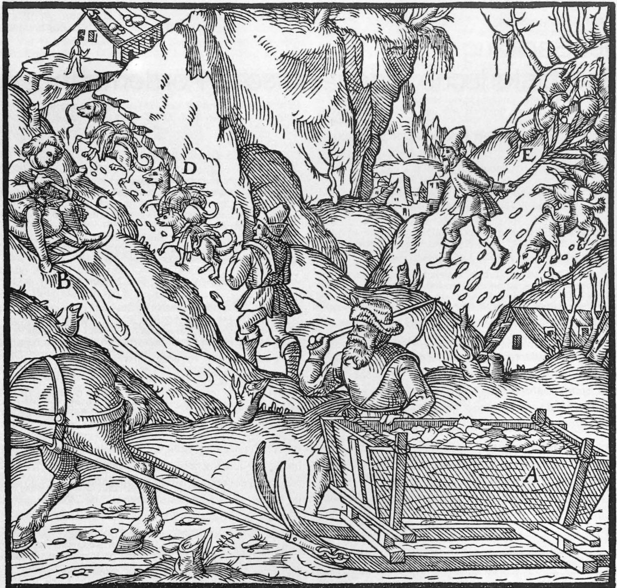
Abb. 1: Erztransport nach Agricola, A: Schlitten, B: Schleife mit Säcken, C: Stab, D: Hunde mit Saumsätteln, E: An einem Stück befestigte schweinslederene Säcke
