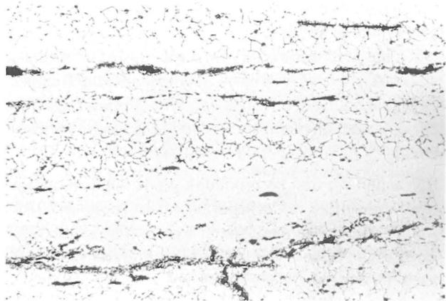
Abb. 19: Typische Mikrostruktur einer Schneide, Vergrößerung ca. 50fach
