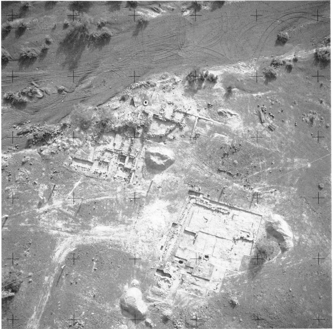
Abb. 5: Meßbild von der Ausgrabung Maysar-1, aufgenommen mit Rollei SLX und 40-mm-Distagon. Der Abstand zweier Reseaukreuze entspricht etwa 16 m
