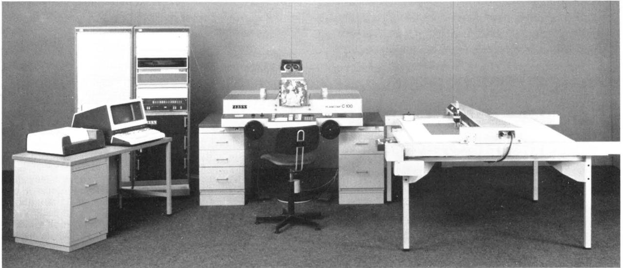
Abb. 1: Das analytische Stereoauswertesystem Zeiss Planicom C 100
