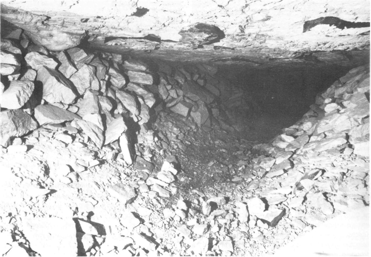
Abb. 20: Wadi el-Sheik. Blick in eine Strecke von Grube 1. Reste des Hornsteinhorizontes befinden sich noch an der Firste. Der seitliche Versatz ist obenauf deutlich größer als unten
