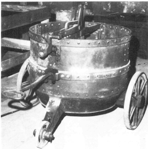
Abb. 5: Bodenentleerer Wagen für die Begichtung des Hochofens; ursprünglich im Radwerk III eingesetzt, jetzt im Radwerk IV
