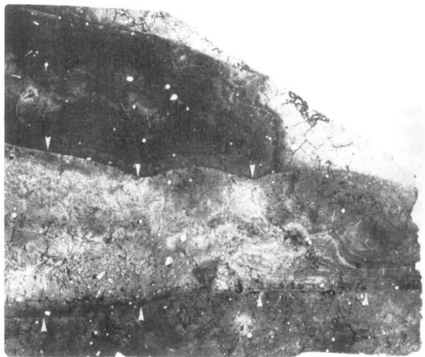
Abb. 19: Fenan 5. Kupferschlacke der Eisenzeit II C. Die nur partiell kristallisierte, überwiegend glasig erstarrte Schlacke zeigt mehrere übereinandergeflossene Lagen, die jeweils Abkühlungsränder aufweisen (Pfeile). Dies deutet auf einen Abstich der Schlacke in mehreren Etappen. Probe JD-1/4, Größe der abgebildeten Schlacke: 2,5 cm
