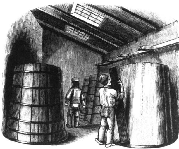
Abb. 6: Wachsfässer zum Kristallisieren von Alaunlösungen
