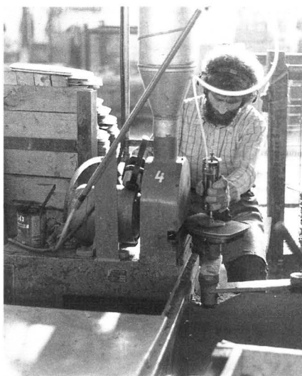
Abb. 5: Mayen (Hunsrück). Dachschiefergrube Katzenberg: Maschinelles Zurichten (randliches Beschneiden) der Schieferplatten (Foto 1982)
