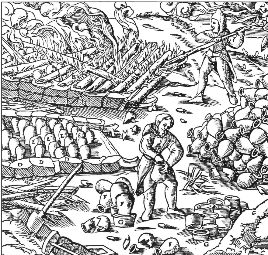
Antimongewinnung nach Agricola: A = Brennende Feuerstätte, B = Feuerholz, C = Nichtbrennende Feuerstätte, in die man die Töpfe setzt, D = Steine, E = Topfreihen, F = Obere Töpfe, G = Untere Töpfe
