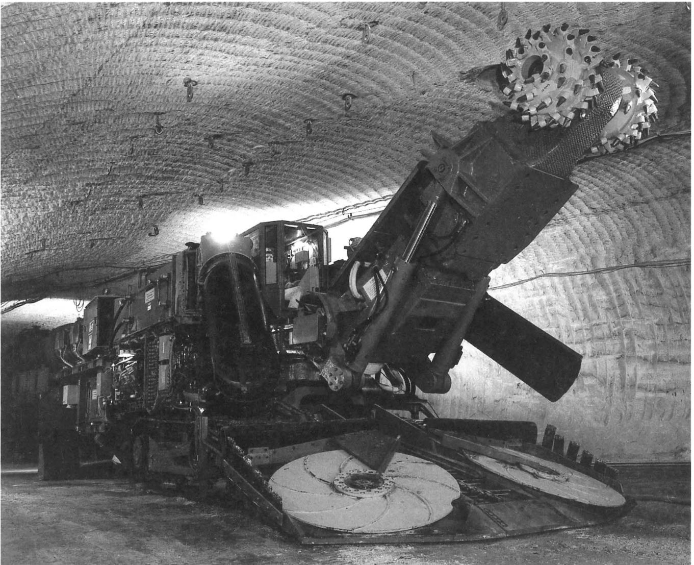
Abb. 4: WAV 400 von Westfalia Lünen für forcierte Streckenvortriebe ab ca. 1985
