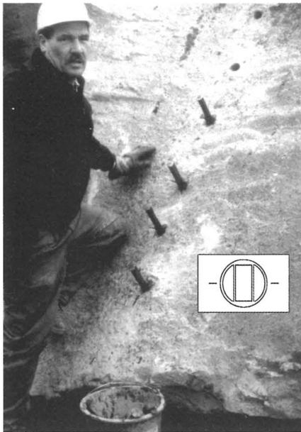
Abb. 9: Einsatz sog. „Patentkeile“ für die Spaltung von Basaltlava, „Patent“ ist eigentlich das Keilfutter. Durch seinen speziellen Querschnitt (siehe Kasten) können Keile auch im Bohrloch gezielt, anstatt in alle Richtungen wirken
