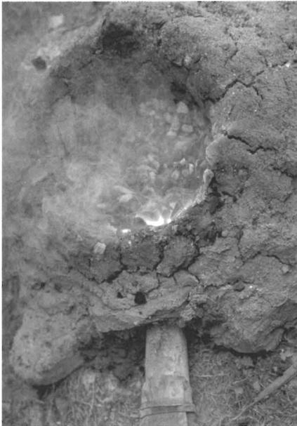
Abb. 23: Schmelzversuch zur Reduktion von Bleiglanz zu Blei
