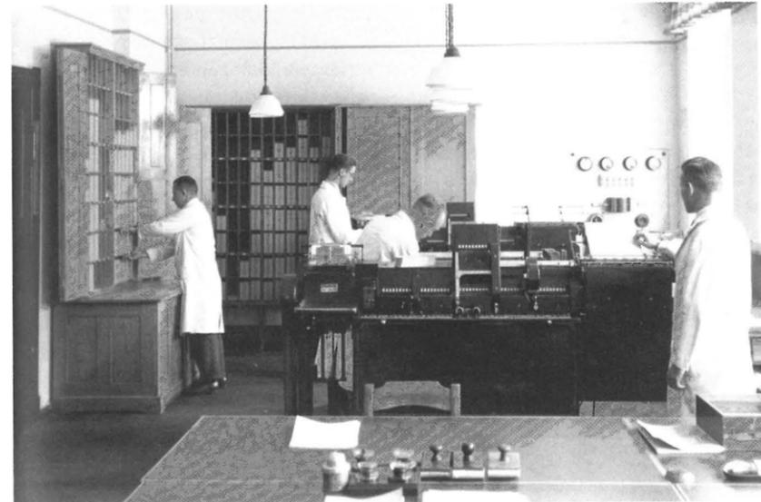
Abb. 9: Blick in den Maschinensaal der Hollerithabteilung mit Tabelliermaschinen und Lochkartenregalen, 1938
