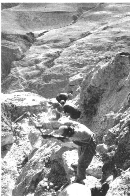
Abb. 3: Salzabbau am Taqča Khana-Diapir. Eine neue Abbau-Scheibe wird nach dem Abräumen von Residualton (rechts) eröffnet. Der Blick geht nach WSW über die Schlucht des Rod e Namakab auf den kleinen Westteil des Salzstocks
