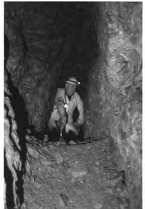
Abb. 15: „Vor Ort“ in einem auf dem Versatz von unten nach oben vorrückenden „Firstenbau“ der auch auf Kupfererze verliehenen Grube Milde Hand in der unmittelbaren Fortsetzung der Ramberger Gänge bei Niederdreisbach
