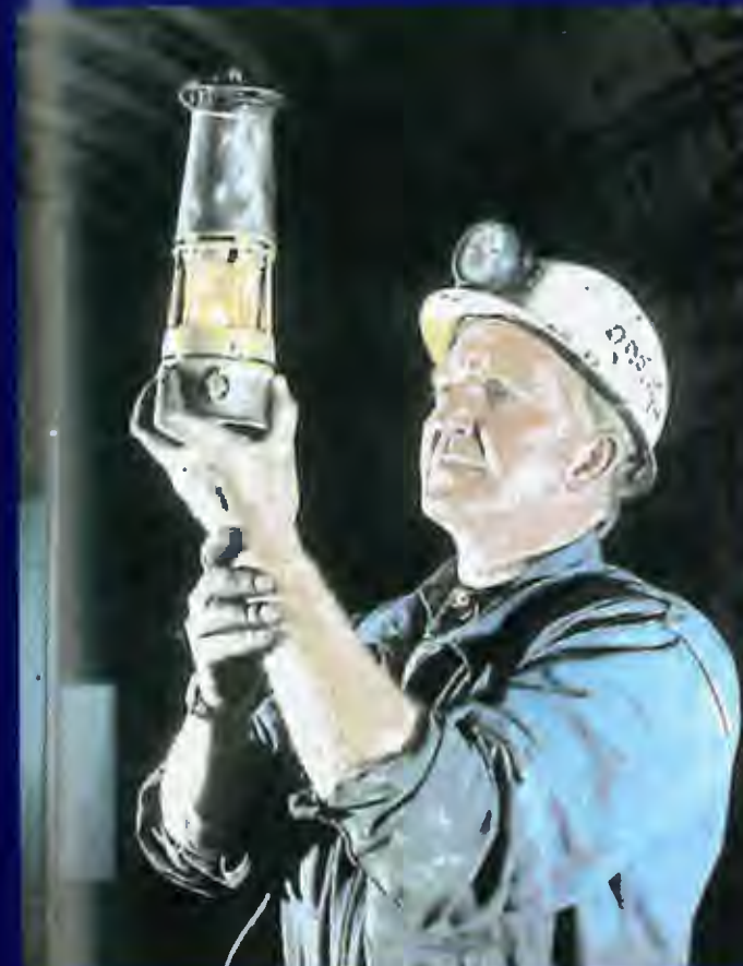
Abb. 32: Roost-Warendin, Wettermessung auf der Schachanlage 9 von l'Escarpelle, 1977 (Lewarde, Centre Historique Minier) / Fig. 32: Mesure de grisou à la fosse 9 de l'Escarpelle à Roost-Warendin, 1977. Centre Historique Minier
