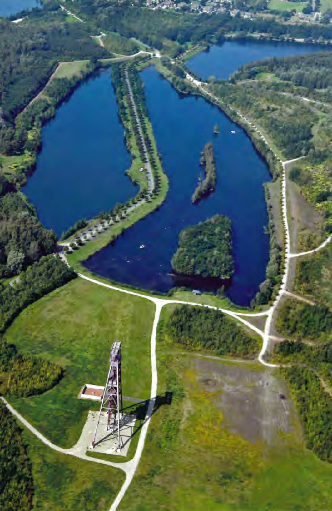
Abb. 4: Condé-sur-l'Escaut, Fördergerüst über dem Schacht Ledoux und wassergefüllte Bodensenkung / Fig. 4: Chevalement de la fosse Ledoux et étang d'affaissement à Condé-sur-l'Escaut
