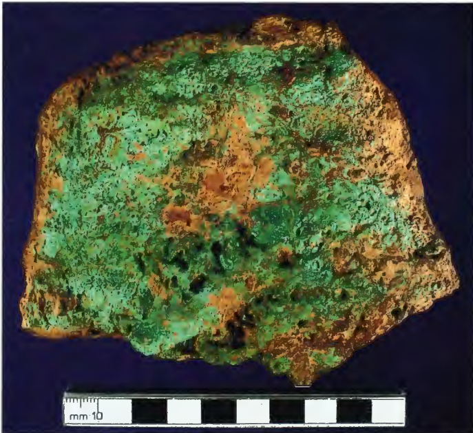
Abb. 11: Shashkoc, Reicherze: a massiver Kupfererzbrocken (Malachit), b Fahlerz in Quarzband
