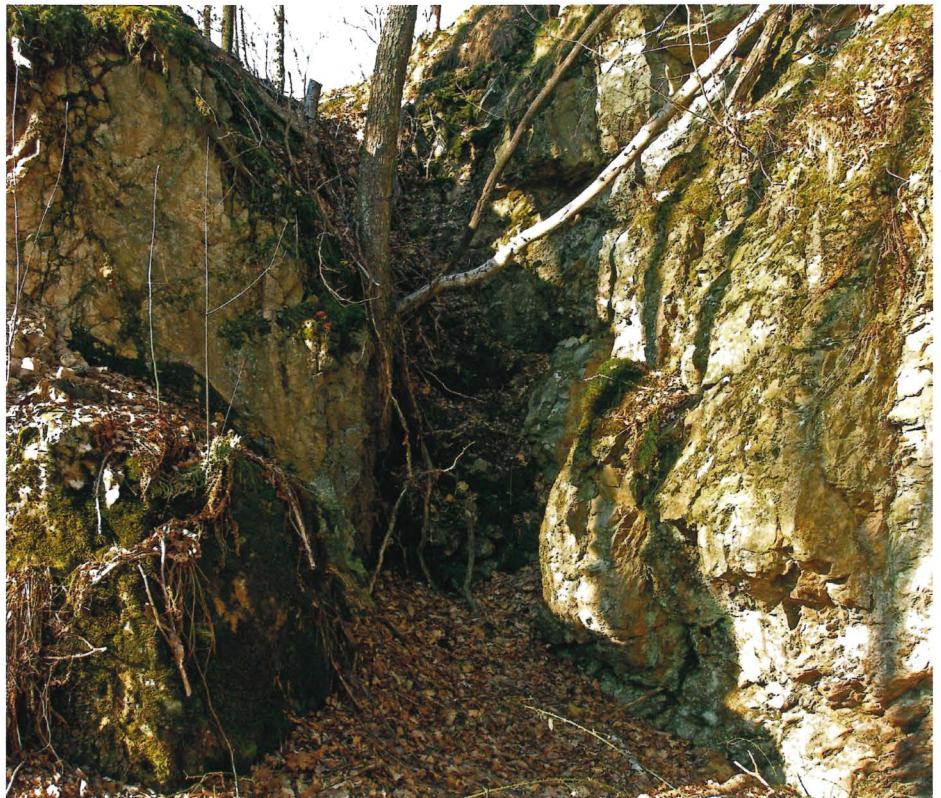
Abb. 2: Die in der Hauptpinge der Grube Alte Guldenhardt noch erkennbaren Reste eines Strossenbaus. An dieser Stelle begann man zwischen dem oberen und dem damaligen tiefen Stollen (heute mittlerer Stollen) in den Jahren 1777/78 mit dem Firstenbau
