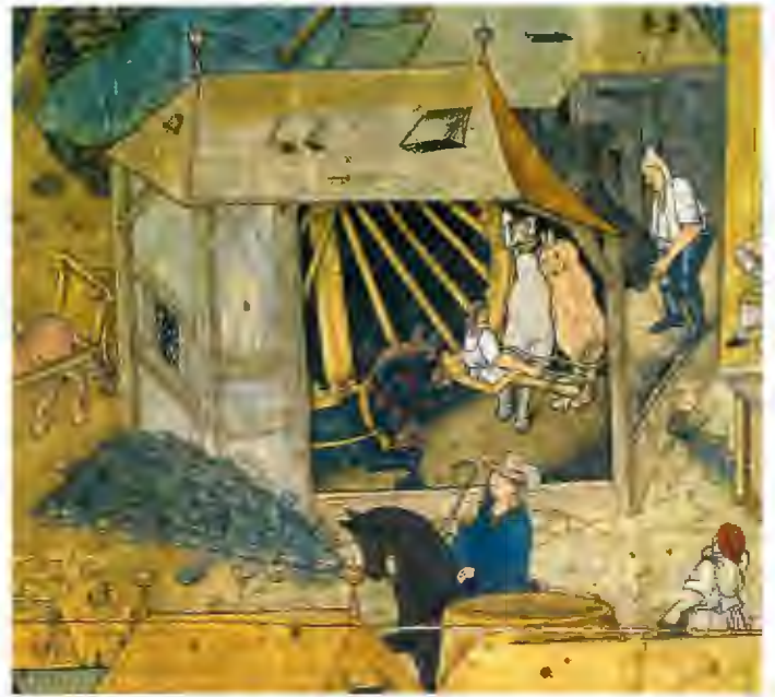
Abb. 8: Der zur Förderung dienende Pferdegöpel (Ausschnitt aus dem Einzelblatt)
