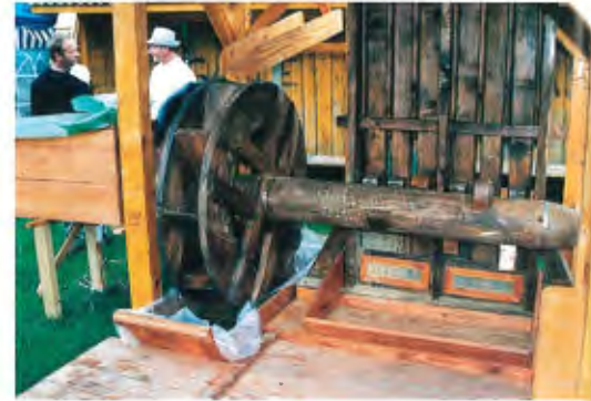
Abb. 6: Vorführung eines Großmodells mit sechs Pochstempeln
