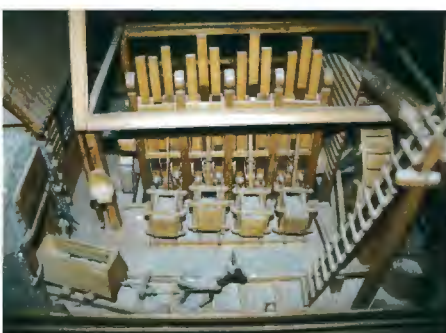
Abb. 4: Pochwerksmodell mit 12 Schießern (Pochstempel) in Roşia Montană
