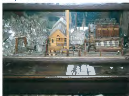
Abb. 5: Vom Bergmann Ioan Modura aus Roşia Montană gebautes Modell, mit Stollenmundloch, Erzkram, Pochwerk
