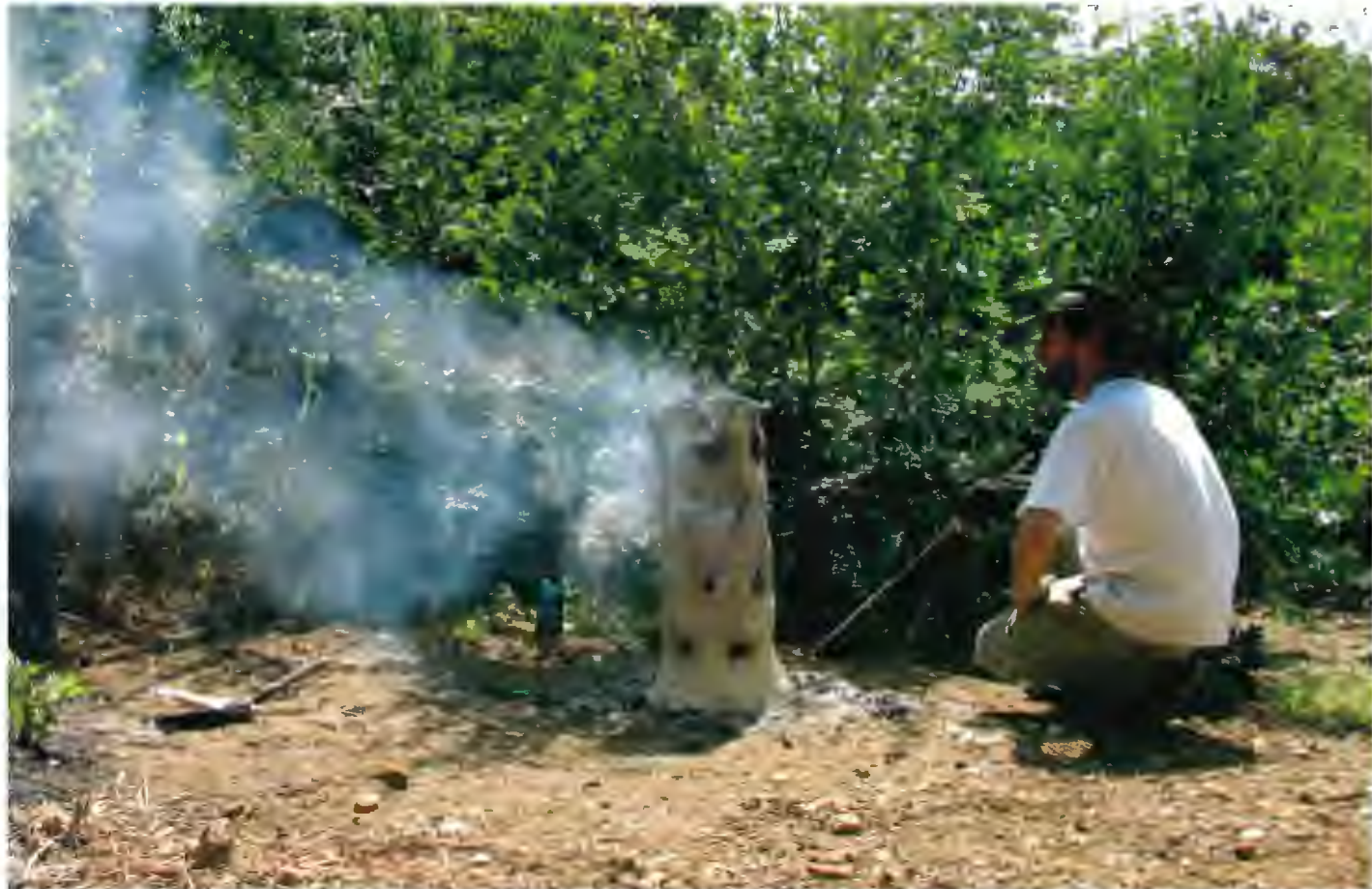
Abb. 16: Rekonstruktion eines huayrachina für Schmelzversuche
