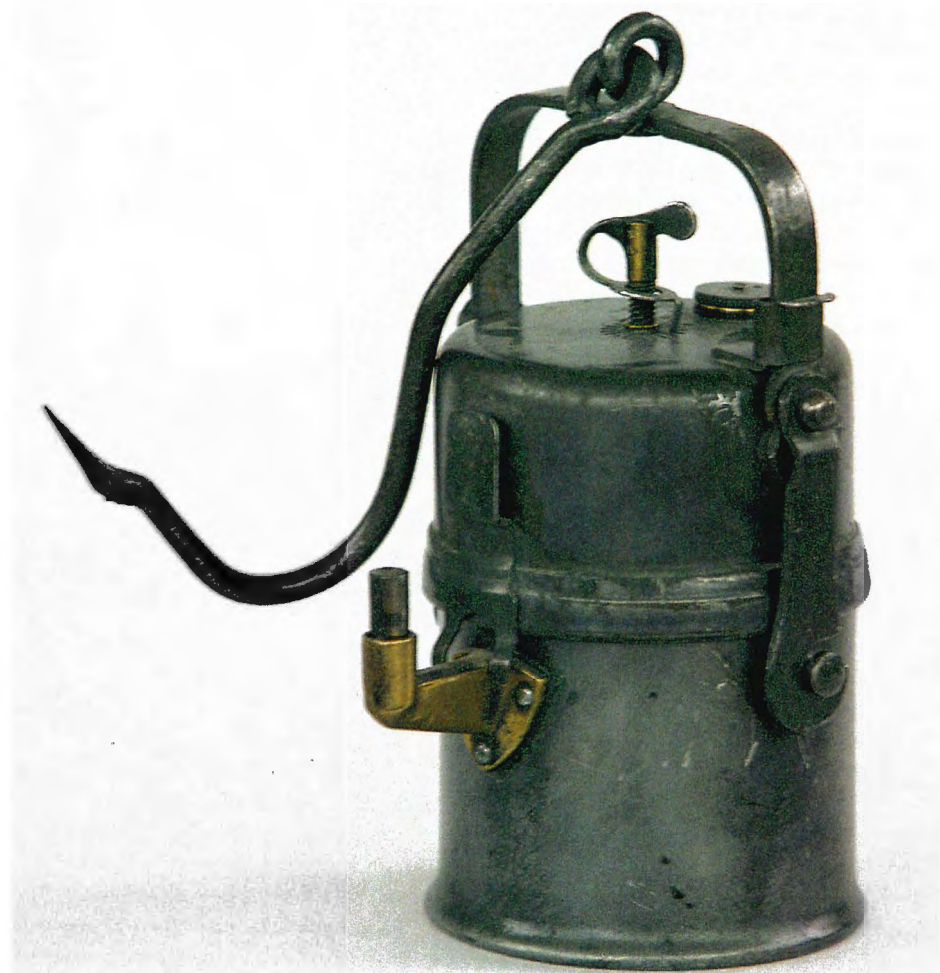
Abb. 1: Karbidlampe vom Typ 850, Größe I
