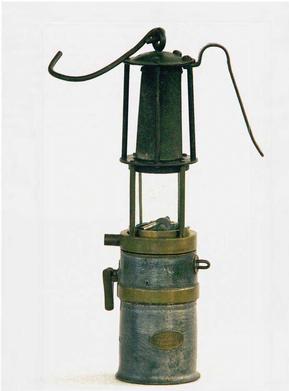
Abb. 5: Kabinetwetterlampe Typ 800 von Wolf-Pokorný, Größe III
