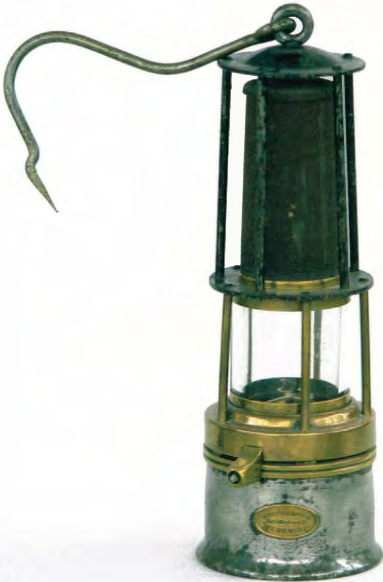
Abb. 7: Benzinwetterlampe vom Typ 300 mit Schraubverschluss
