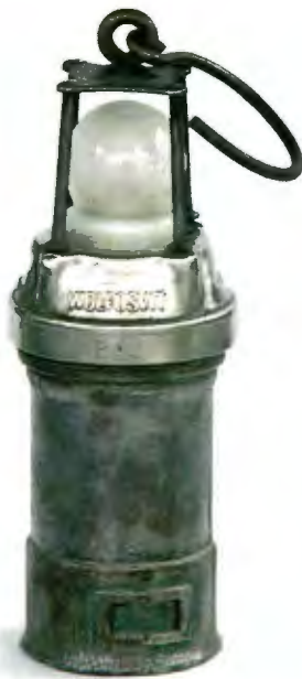
Abb. 10: Elektrische Akkulampe vom Typ 850 Wolfosvit
