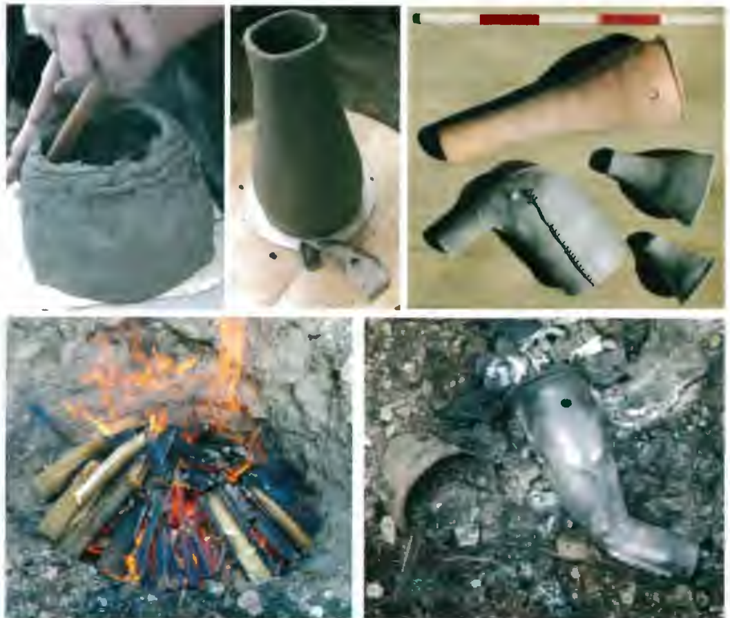
Abb. 15: Herstellungsprozess für die keramischen Düsen: Wulstaufbau und Grubenbrand
