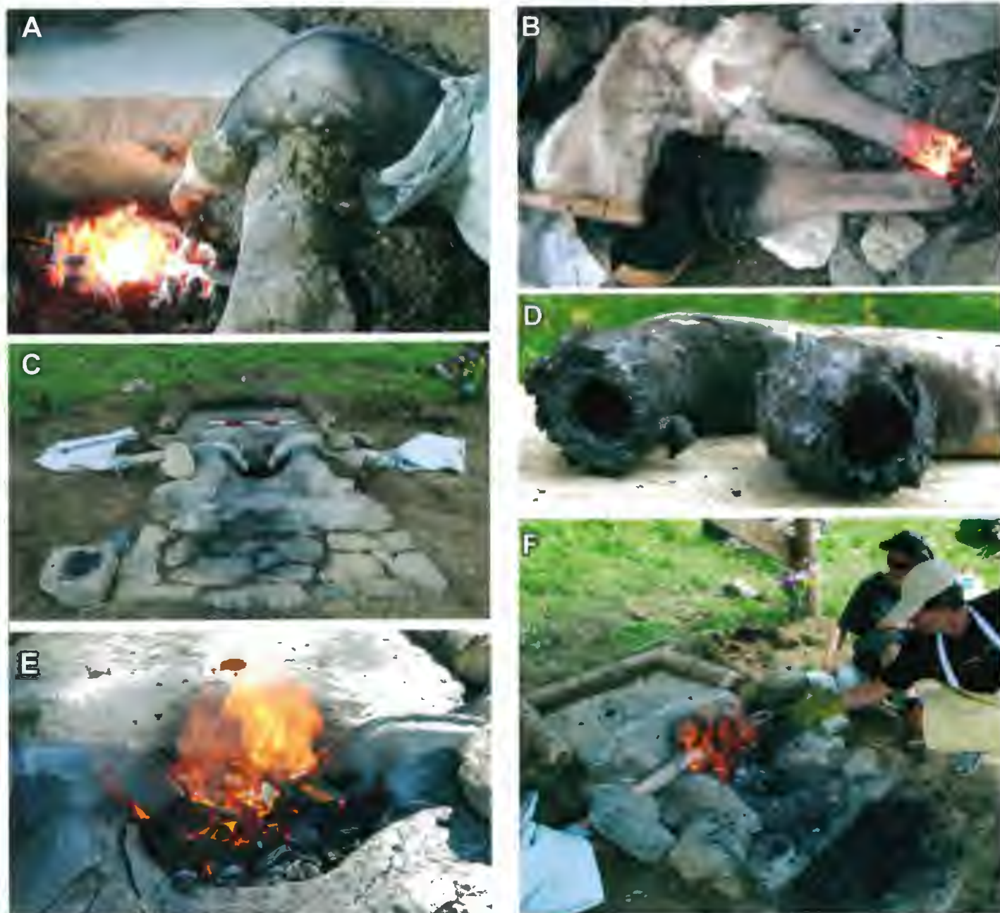
Abb. 17: Verwendung eines keramischen Zwischenstücks (A), um Verschlackungen der Düsenspitze zu vermeiden (B, D); Der „Nepal-Prozess“ (C, E, F), Versuchsreihe 2012 in Jochberg, Tirol
