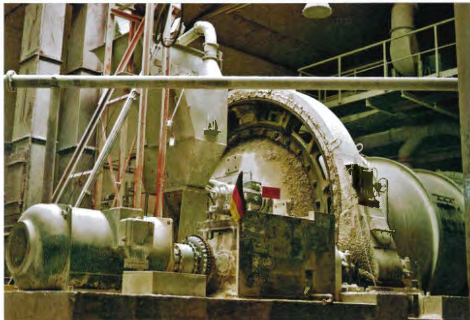
Abb. 4: Nassmahlverfahren mit anschließender Reinigung zur Erzeugung hellstes natürliches Schwerspatmineralpulver
