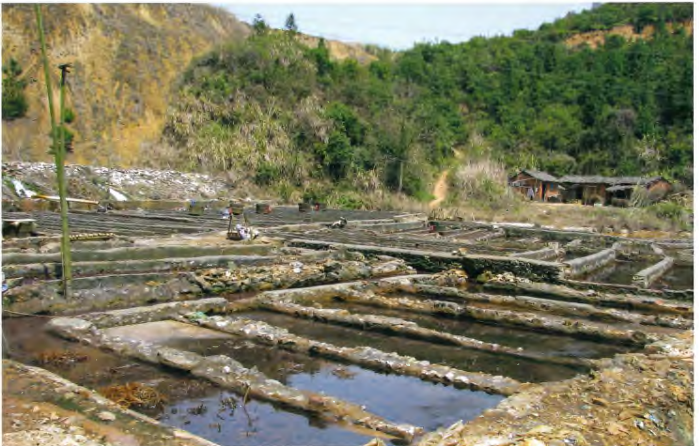
Gräben zum Tunken des Eisens in der Anlage von Shihaoba 十號壩 nahe Yanshan 鉛山, Provinz Jiangxi
