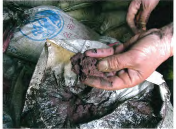
Das vorläufige Ergebnis des Nasskupferproduktionsprozesses: Kupferschlamm. Anlage von Shihaoba
