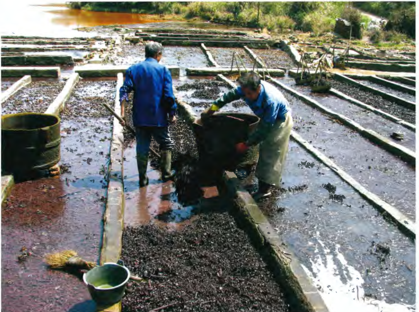
Nach dem Waschen wird das Eisen zurück in die Gräben geworfen, Anlage von Shihaoba
