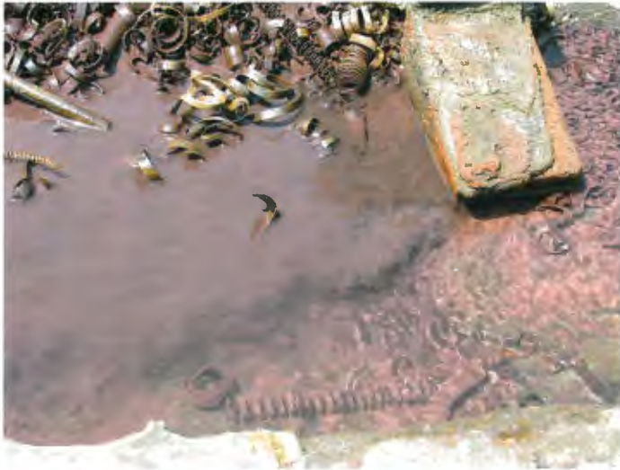
Trübung des Wassers in Folge der Ersetzungsreaktion in der Anlage von Shihaoba
