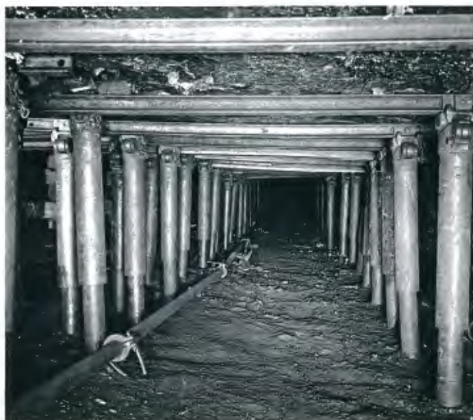
Abb. 4: Sprungstempel mit unverbundenen Kappen aus GI-Profil
