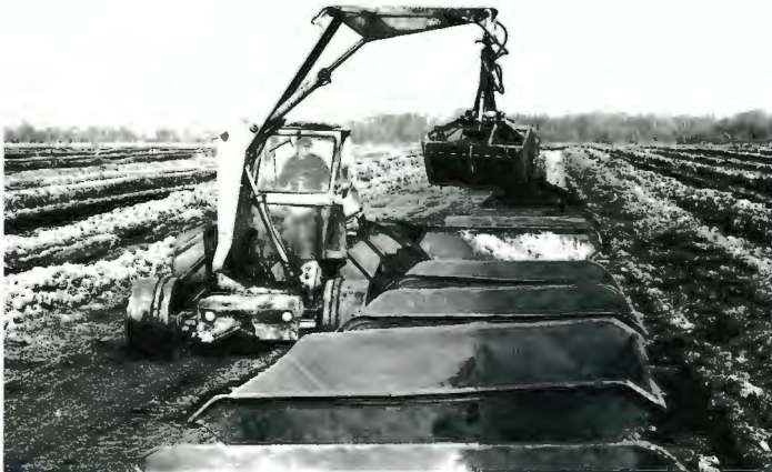
Abb. 9a: Torfbergung im Drispether Moor mittels Torfbagger Typ Eigenbau/T 174 (1970er-Jahre)
