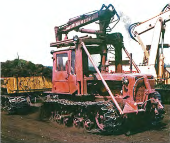
Abb. 9b: Torfbergung im Weitendorfer Moor mittels sowjetischer Moor-Transportmaschine Typ MTF 13 im Jahr 1983
