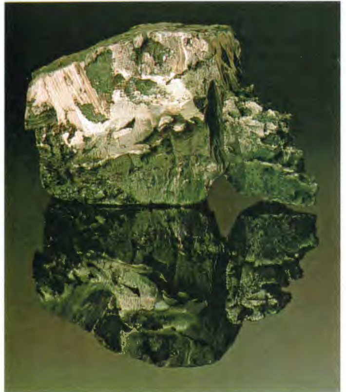
Abb. 11: Belegstück aus dem 1477 in der Grube Sankt Georg in Schneeberg im sächsischen Erzgebirge gefundenen Reicherzfall mit rd. 20.000 kg Silber, bestehend hauptsächlich aus gediegenem Silber und Argentit (nach Quellmalz 1990)
