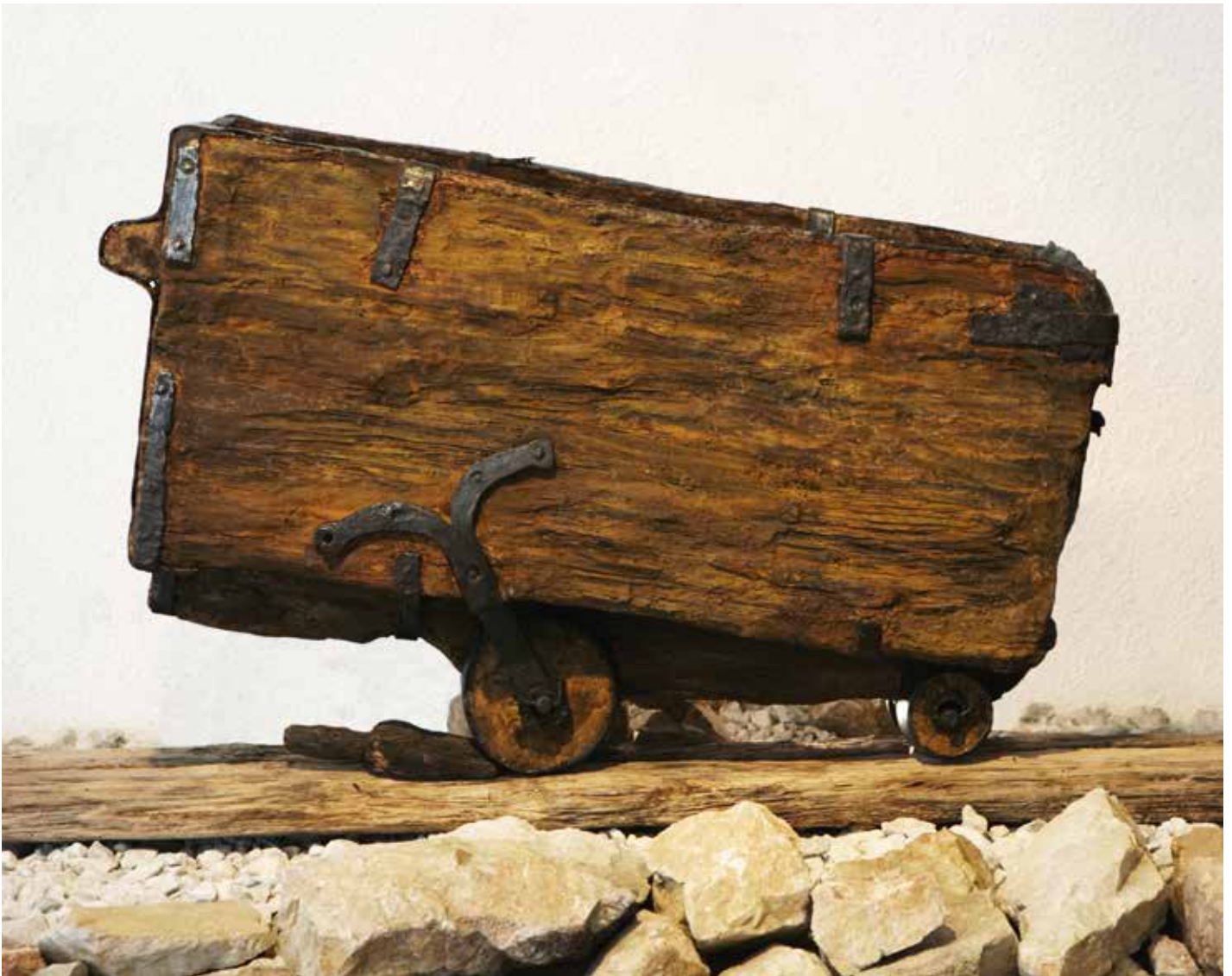
Abb. 1: 200 Jahre alter Spurnagel-Hunt vom Kupfer- und Silberrevier Gratlspitz, Gemeinde Alpbach/Tirol, der heute im Tiroler Bergbau- und Hüttenmuseum Brixlegg gezeigt wird. Die Auffindung des fast unversehrten, hölzernen Förderwagens in einem Stollen, der weit entfernt des Schatzbergs und der Silberalm im Jahr 1987 war eine Sensation. (© Foto: Katharina Fröschl-Roßboth, Wien)
