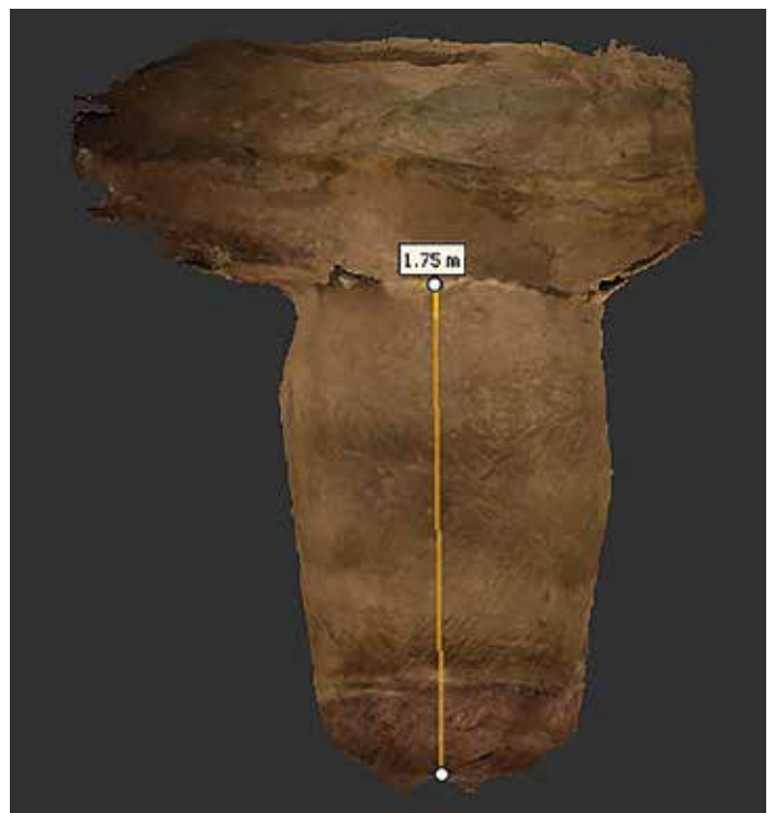
Abb. 25: Das Gesenk, Ausschnitt aus dem 3D-Modell. Dicht über der Sohle ist die wasserführende Schicht deutlich am Farbwechsel zu erkennen. (© Fotos: M. Musberg, DBM. 3D-Umsetzung: N. Schimerl, DBM)
