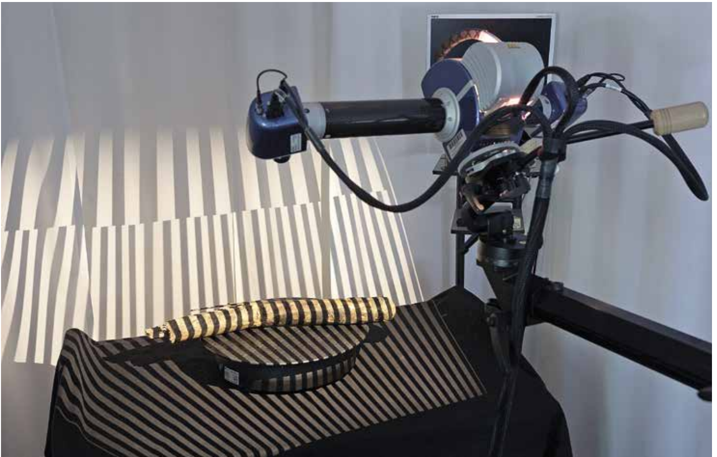
Abb. 12: 3D-Scan eines Rundholzes aus Dippoldiswalde mit dem Streifenlichtscanner. (© Landesamt für Archäologie Sachsen; Foto: T. Reuter)
