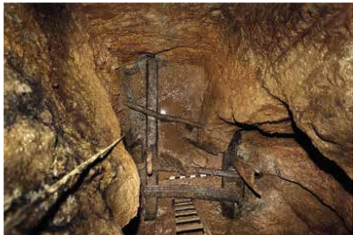
Abb. 1: Reste einer Haspel in einem Schacht von Dippoldiswalde, Glashütter Straße (DW-27). Die Bretter der zugehörigen Hängebank datieren in das Jahr 1212 (sichere Waldkante). (© Landesamt für Archäologie Sachsen; Foto: F. Schröder)
