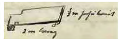
Abb. 6: Die Skizze von Bruno Knochenhauer zeigt einen von den koreanischen Goldwäschern genutzten Holzkasten, mittels dem in einem Fließgewässer der Schotter von Schlamm gereinigt wurde. (© Skizze: Bruno Knochenhauer/SLUB Dresden. Sig. Mscr. Dresd.App.3045, S. 195)
