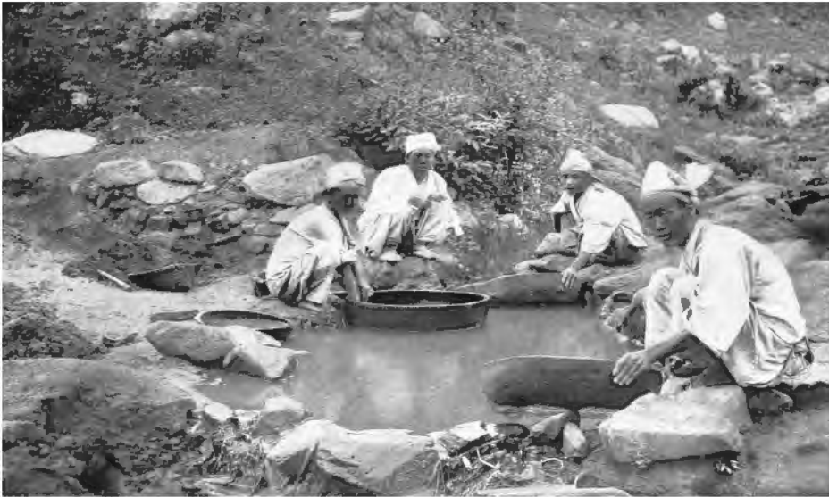
Abb. 7: Koreanische Goldsucher beim Waschen von Gold. In den Holzpfannen wird das Gold durch eine drehende Bewegung von der Erde getrennt. (Quelle Foto: Homer Bezaleel Hulbert: Passing of Korea . Doubleday, Page & Company. New York 1906. S. 274)
