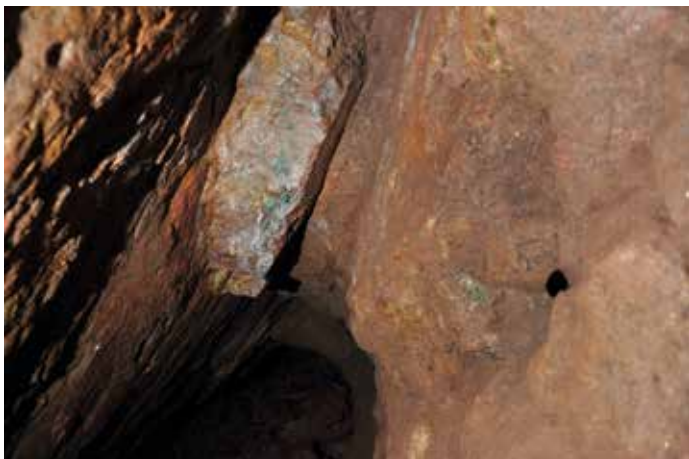
Abb. 10: Beispiel für das Schneiden des Quarzgangs mit Schlägel-und-Eisen-Arbeit und Aufweitung mit Schießpulver, Mine St-Charles, Le Thillot. (© Foto: SÉSAM)
