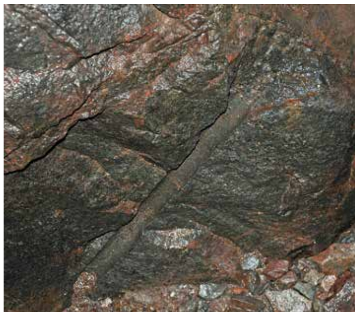
Abb. 26: Bohrloch mit Starttrichter, Mine St-Thomas, Le Thillot. (© Foto: SÉSAM)
