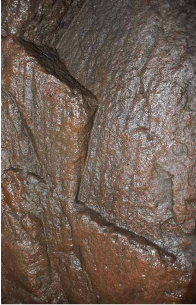
Abb. 21: Detail der progressiven Bearbeitung der Stufen durch Schlägel- und-Eisen-Arbeit, Le Thillot. (© Foto: SÉSAM)
