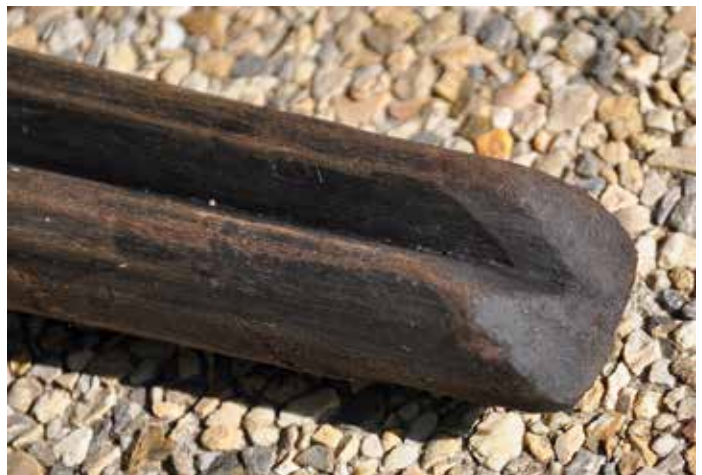
Abb. 38: Ende der Zündschnurführung, Mine St-Charles, Le Thillot. (© Foto: SÉSAM)
