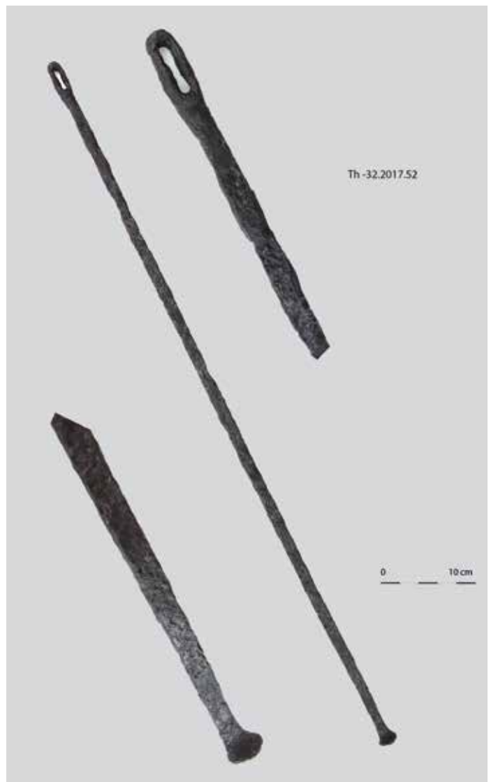
Abb. 34: Bohrkrätzer zum Reinigen und Trocknen des Sprenglochs, Mine St-Charles, Le Thillot. (© Foto: SÉSAM)
