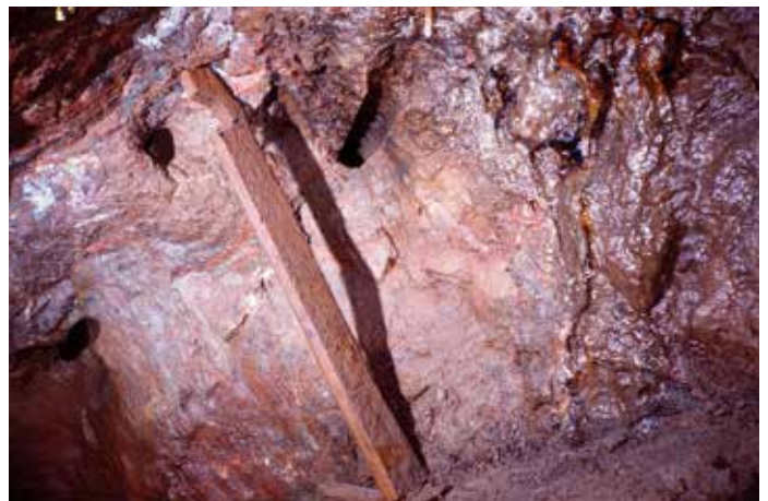
Abb. 11: Bohrerhalterung vor einem Bohrloch, gefunden in der Mine St-Nicolas, Le Thillot. (© Foto: SÉSAM)
