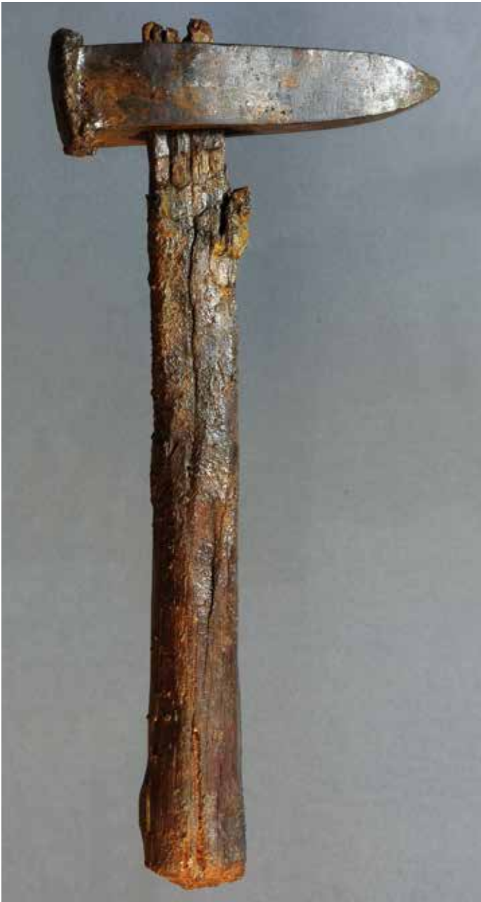
Abb. 28: Bergeisen mit Griff, Mine St-Charles, Le Thillot. (© Foto: SÉSAM)
