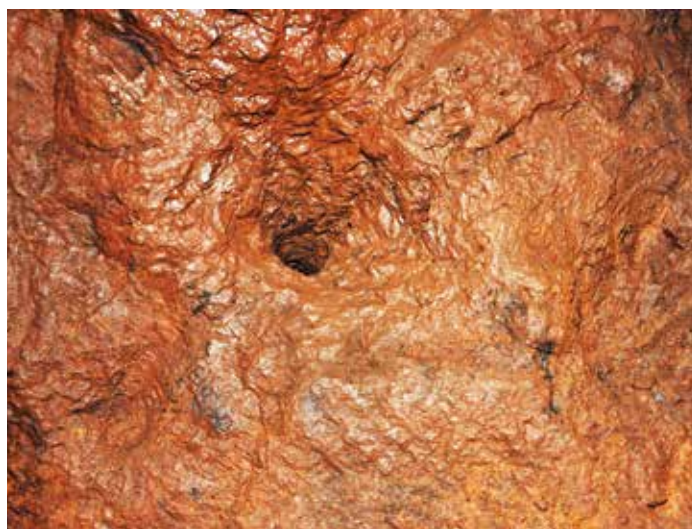
Abb. 27: Überreste der Bergeisenpräparation eines nicht herausgesprengten Lochs, Mine St-Charles, Le Thillot. (© Foto: SÉSAM)
