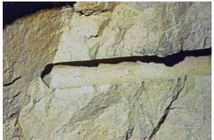
Abb. 8: Wandspuren in den Bergwerken von Le Thillot, die durch Schießpulversprengungen entstanden sind. (© Foto: Société d'Étude et de Sauvegarde des Anciennes Mines (SÉSAM))
