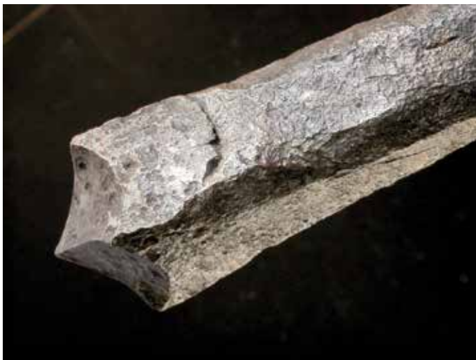
Abb. 40: Schneidekopf des Typ-II-Bohrer, Mine St-Charles, Le Thillot. (© Foto: SÉSAM)
