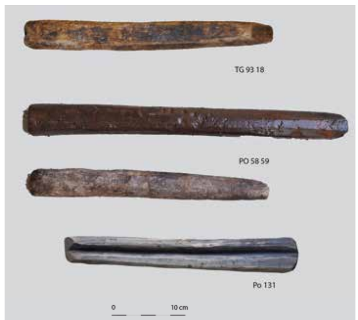
Abb. 35: Holzpflock und „Épinglette“ (Stecknadel, Schießnadel) zur Führung der Zündschnur, Mine St-Charles, Le Thillot. (© Foto: SÉSAM)
