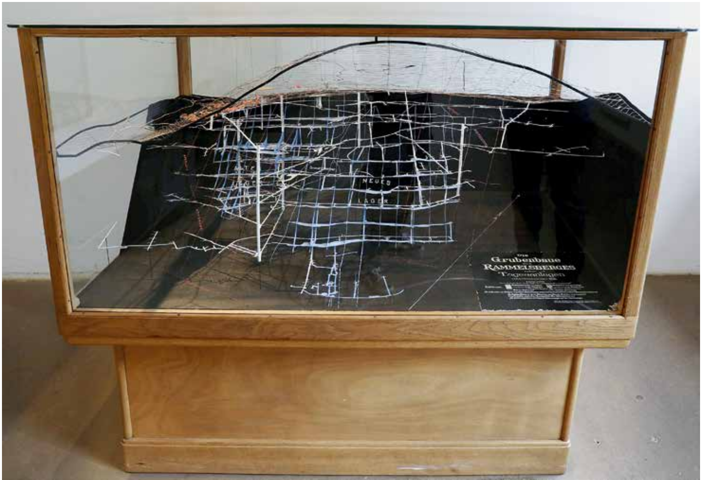
Abb. 1: Lagerstättenmodell „Die Grubenbaue des Rammelsberges nebst Tagesanlagen“ von Oskar Langer aus dem Jahr 1932. (© Foto: J. Meyer/TU Clausthal)
