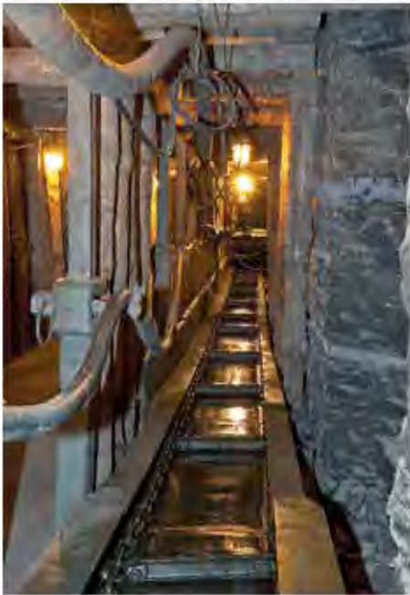
Abb. 2: Zweikettenkratzförderer im Anschauungsbergwerk. (© Foto: P. Franke)
