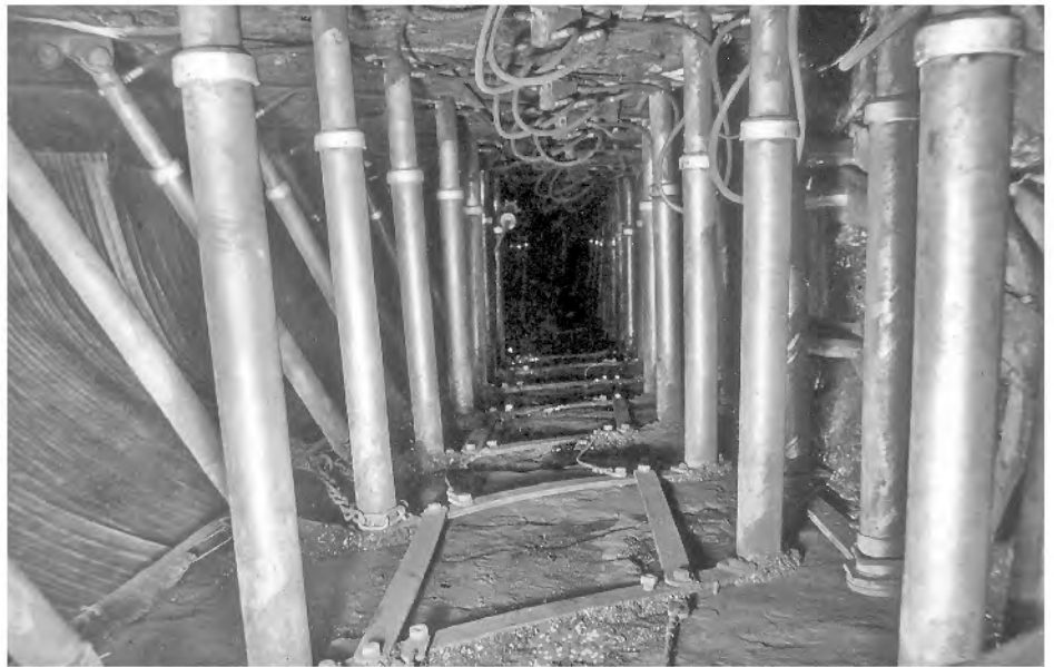
Abb. 2: Schwenkrahmen mit Versatzmatte links auf Ickern 1954 im Versuchsstreb Mausegatt. (Ferromatik)
