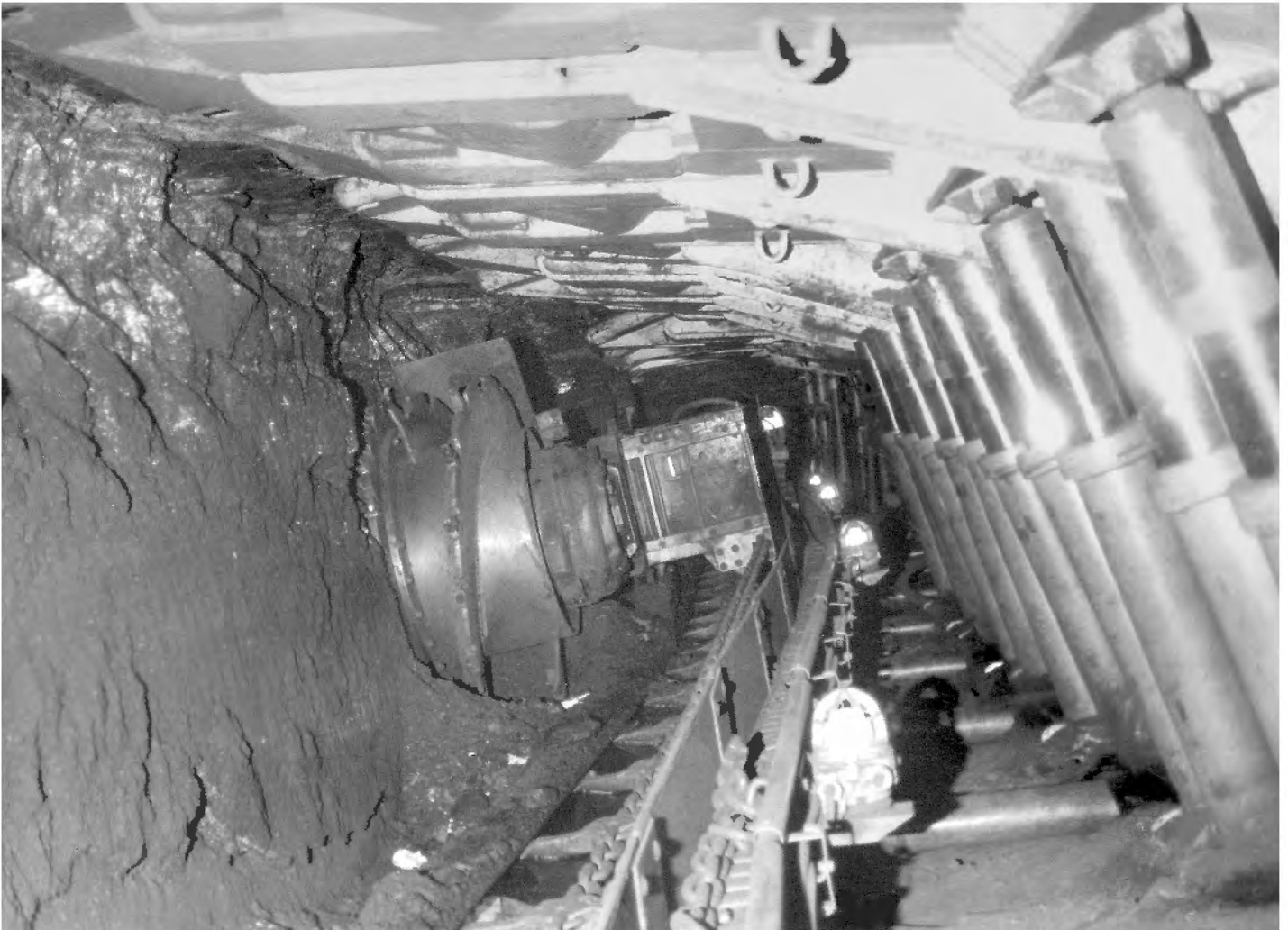
Abb. 9: Der Eickhoff-Walzenlader EW 170 L im Flöz Mathias 1 BA 3 a Ickern, 1970. (Sammlung Norbert Brandenburg)
