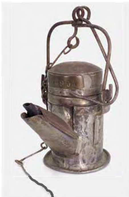
Abb. 4: Typischer Obernkirchener Krüsel (Handschelle) aus dem Jahr 1900. Aufgelötete beschlagartige Platten-Attaschen aus Weißblech. (Privatsammlung, © Foto Hartwig Büttner)
