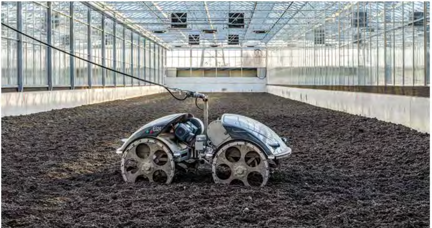
Abb. 7. Solare Schlamm-trocknung (SST) mit „elektrischem Schwein“, Bottrop, 18. Dezember 2020. (© Klaus Baumers/Emschergenossenschaft)
