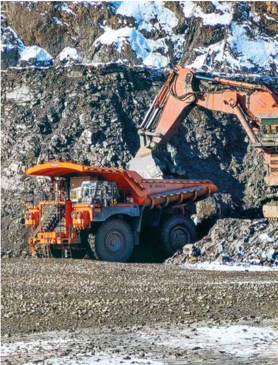
Abb. 2: Abbau im Tagebau (der Kipper hat bereits 15t Ladung aufgenommen). (© Foto: Lorenz Rothe)
