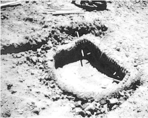
Abb. 9: Unterer Teil des im Bau befindlichen Verhüttungs-ofens 3 in Fenan 9. Der Ofen wurde aus örtlich anstehendem, mit Stroh gehäckseltem Mergel errichtet. Anstelle der in den Wänden steckenden, horizontal verlaufenden Holzstöcke wurden beim Schmelzversuch Thermoelemente eingesetzt. An den thermisch besonders beanspruchten Bereichen der Ofenfront wurden gebrannte Tonstäbchen als zusätzliche Armierung eingebaut.
