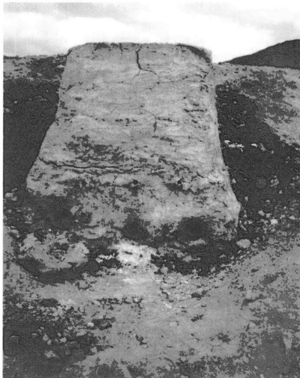
*Abb. 16: Vorderansicht des VerhüttungsOfen 3 nach dem Experiment. An der Ofenfront haben sich Risse gebildet, durch die z.T. Falschluf ins Innere des Ofens gelangte.*
