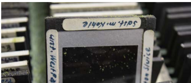
Verunreinigungen auf einem Kleinbild-Dia durch Partikel eines zersetzten Polsterschaumes (Foto: Urs Brachthäuser, montan.dok)
