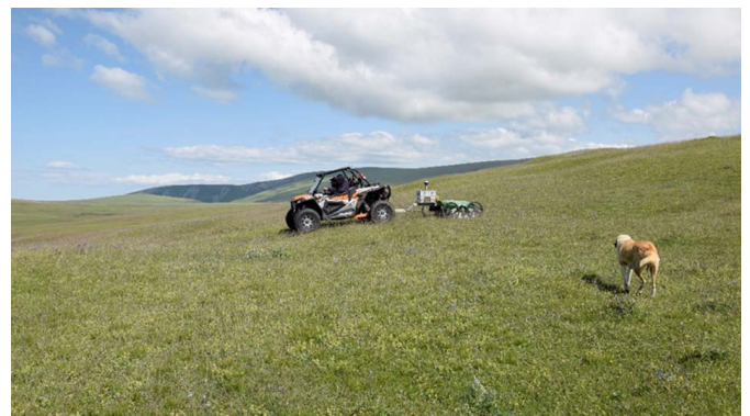
Abb. 11. Motorisierte Georadar-Messung der Projektpartner der Geosphere Austria auf den tellerförmigen Pingens des prähistorischen Obsidianabbaues in Chikiani, Foto: DBM/RUB, Th. Stöllner
